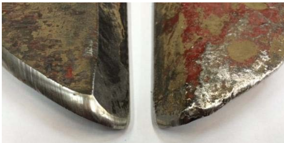
Рисунок 6.3.5 – Виды ненаплавленного (слева) и наплавленного (справа) долот из стали Б1500 лемехов после наработки 5 га на корпус в СПК «Кузьминский».
