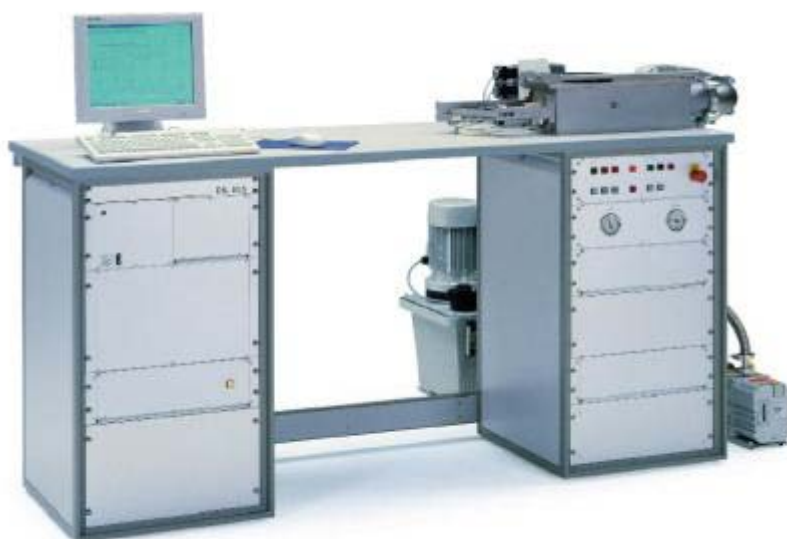
Рисунок 2.2.1 - Высокоскоростной закалочно-деформационный дилатометр DIL-805
