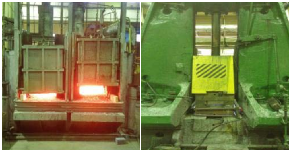
Рисунок 5.3.2.2 – а) нагревательные камерные электрические печи; б) штамповочный молот М-2145А с подогреваемыми штампами
