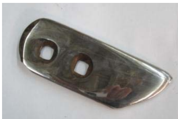
Рисунок 6.3.2 – Вид опытного долото после наработки на корпус более 70 га в СПК «Крапивинский».
