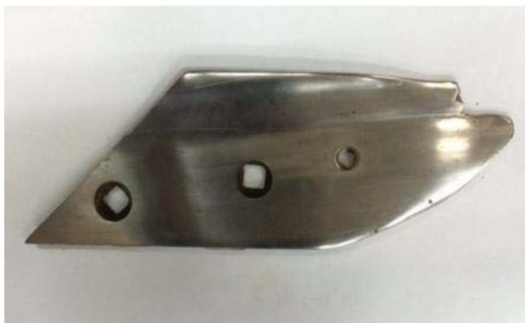
Рисунок 6.3.4 – Вид изношенного долота из стали Б1700 после наработки 45 га на корпус в тяжелых почвенных условиях СПК «Кузьминский». Деталь близка к предельному состоянию
