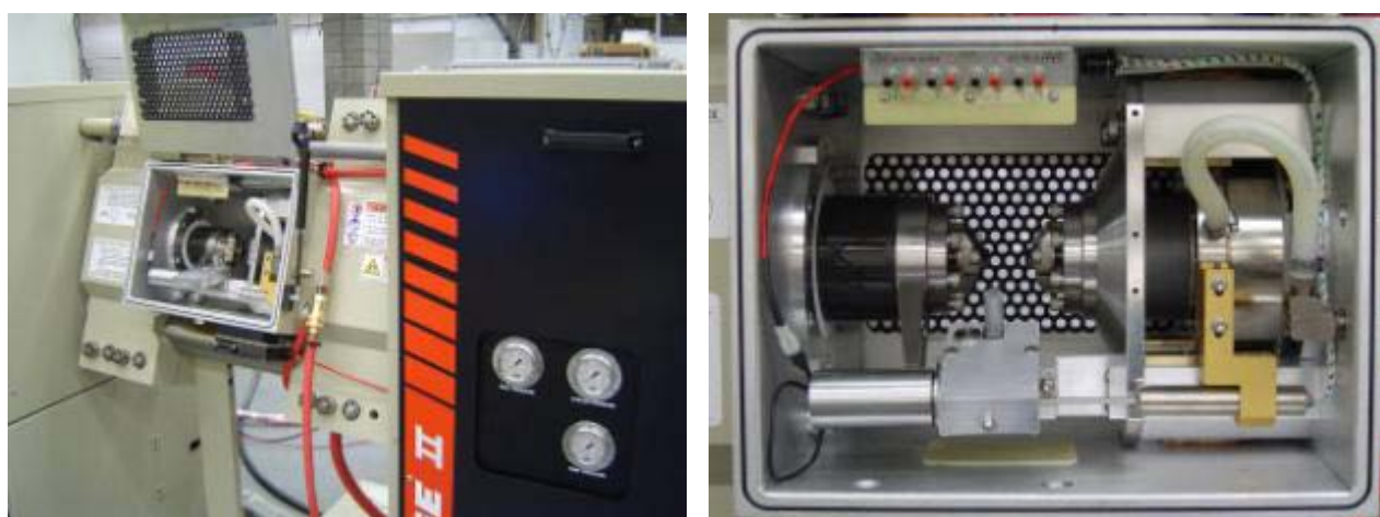
Рисунок 2.3.1 - Модуль испытательного комплекса Gleeble – 3800 для выполнения деформации сжатием или растяжением «Гидромолот» Hydrowedge.
