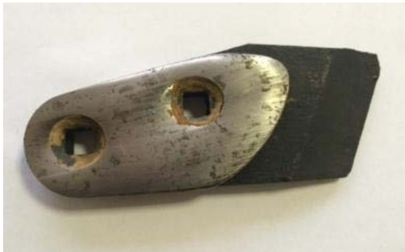
Рисунок 6.3.3 - Сравнительный вид нового и изношенного (наложены друг на друга) наплавленных накладных долот лемехов, изготовленных из стали Б1500 до и после наработки 8 га на плужный корпус в тяжелых почвенных условиях в СПК «Кузьминский».
