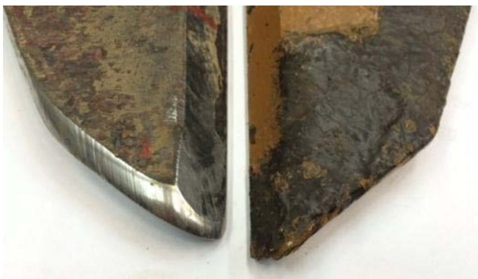
Рисунок 6.3.6 – Виды ненаплавленного (слева) долота из стали Б1500 после наработки 5 га на корпус в СПК «Кузьминский» и аналогичного нового (не изношенного) наплавленного долота (справа)
